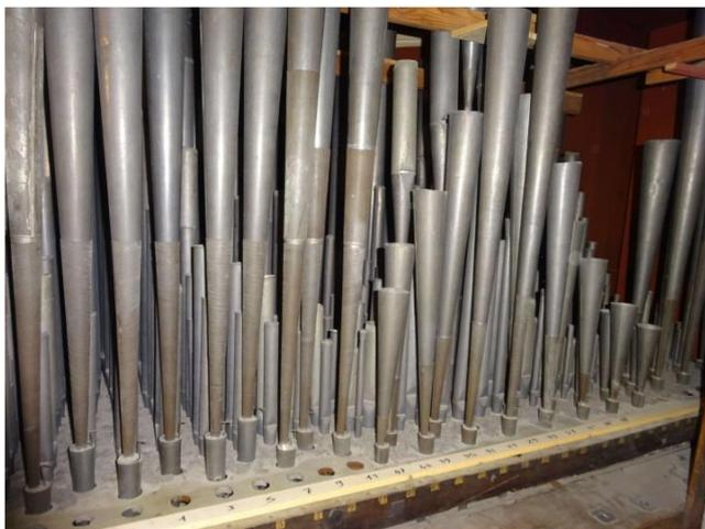
Il deposito di polvere ha coinvolto anche le componenti interne dello strumento; quindi, prima di procedere ai lavori di revisione, si è provveduto alla rimozione delle polveri mediante aspirazione da somieri, mantici, condotti, etc.
